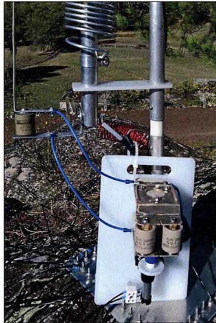
Bild 5: Die 160-m-Modifikation wird anstelle eines Festkondensators eingefügt.
