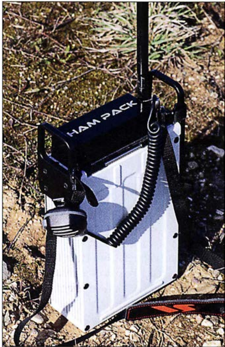
Bild 1: Transportfertiges Ham Pack mit angeschlossenem Mikrophon und aufgesteckter Stabantenne
