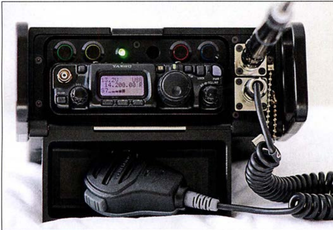
Bild 3: Die Abdeckung für den Yaesu FT-817 dient im aufgeklappten Zustand als Fuß für das Ham Pack. Fotos: DH3PM
