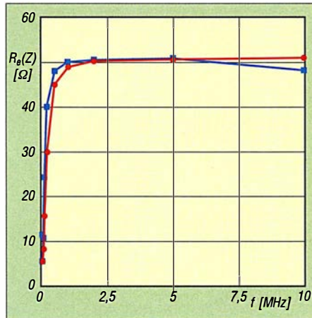
Bild 16: Realteil der nachgebildeten Netzimpedanz (blau) im Vergleich zum kommerziellen Gerät ENV216 von R&S (rot) ...
