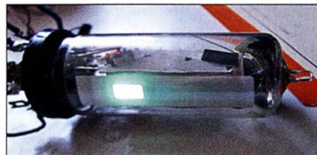
Bild 5: „Magisches Auge“ ist die Bezeichnung für eine Abstimmanzeigeröhre, die die Stärke eines Signals nach dem Prinzip der Bargraph-Anzeige als Leuchtbalken oder -sektor anzeigt. Fotos: Weber
