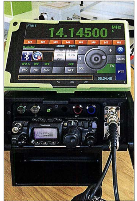
Bild 2: Der Transceiver Yaesu FT-817 im Ham Pack ist per Bluetooth von einem Android-Tablet-PC drahtlos steuerbar.
