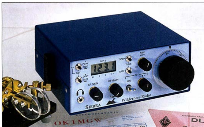
Bild 1: Frontansicht des Transceivers mit der Zusatzbaugruppe digitale Frequenzanzeige/elektronische Taste (für verschiedene Aufrüstungsgrade stehen unterschiedliche Frontplatten zur Verfügung).
