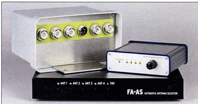
Bild 1: Hardwarekomponenten zur Antennen-Fernumschaltung; unten: FA-AS, darauf liegend der Antennenumschalter für die Montage im Außenbereich und daneben der Prototyp des Interface
