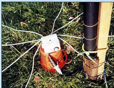
Bild 18: Experiment Groundplane-Antenne mit erdauffliegenden Radials: acht – wie hier gezeigt – sind definitiv zu wenig, 15 oder mehr sind anzustreben. Foto: Red. FA
